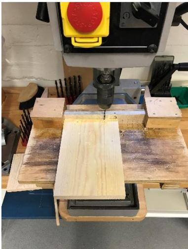
2. Bohre jeweils 2 Löcher  $\varnothing$  4mm, ca. 10mm vom Ende des Brettes, sowie 20mm beidseitig vom Rand, durch die beiden Bretter für die Dachfläche rechts (Länge 213mm) sowie durch den Boden links (Länge 164mm)
