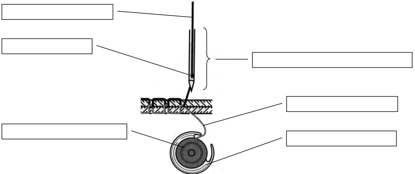
Greifer      Spule      Oberfaden      Unterfaden      Nadelöhr      Nähmaschinennadel
